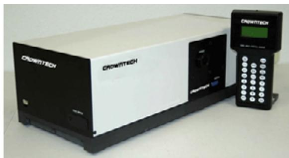
M242 是一种完全计算机控制单色仪，简单易用的指令控制三光栅转台，机动狭缝，可选的电动滤光轮可以快速而便利的选择滤光片。工作模式可设置成恒定光谱分辨率（CSR），可自动调整狭缝宽度以修正补偿因波长扩散而引起的改变，使其保持恒定的光谱带宽。器件表面经过氧化处理，表面防热处理加上直接光栅驱动使设备具有可靠性和耐用性。每种器件在出厂时都经过校准和鉴定。
