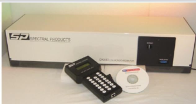
M480 是一个完全计算机控制单色仪。便利的使用指令快速而简便的控制三光栅转台, 电动狭缝, 电动滤光轮。仪器工作方式可设置成恒定光谱分辨率。在这种模式下, 狭缝的宽度会自动调整以修正因为波长改变而引起的色散变化, 这样就可以保证恒定的光谱带宽。器件表面经过氧化处理, 表面防热处理加上 SP 直接光栅驱动使设备具有可靠性和耐用性。每种器件在出厂时都经过校准和鉴定。
