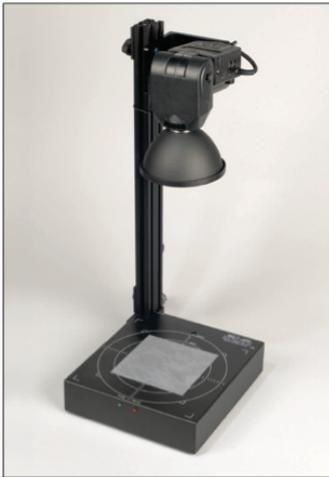
载流子复合寿命的最佳经过校准的测量方式，广泛应用于太阳能单晶和多晶硅片
